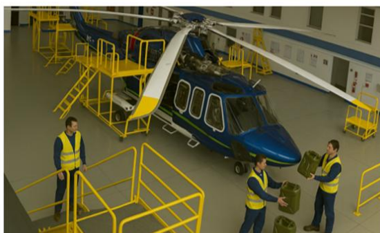
DRENAJE DE COMBUSTIBLE SIN ACORDONAMIENTO DEL AREA Y USO DE EXTINTOR DE EMERGENCIAS
