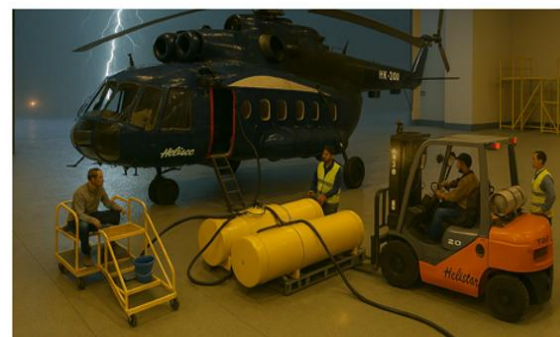
ABASTECIMIENTO DE COMBUSTIBLE DENTRO DE HANGAR Y BAJO CONDICIONES DE TORMENTA
