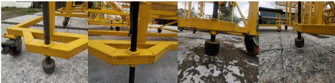
No movilizar equipos ETAA o plataformas de mantenimiento cuando sus frenos estén puestos.
