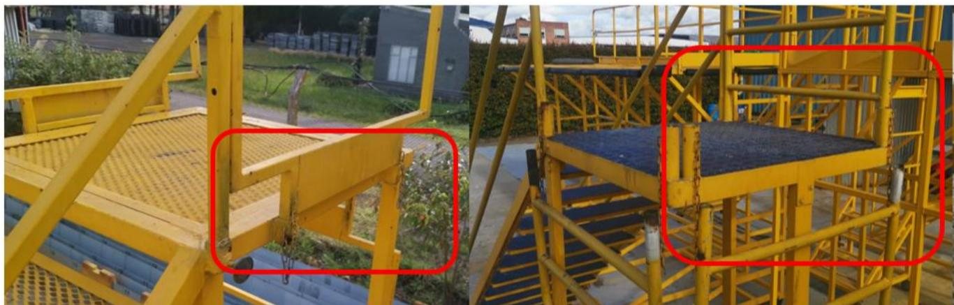
No posicionar objetos pesados sobre los bancos escalera o plataformas de mantenimiento que están diseñados exclusivamente para trabajo en alturas o acceso a las aeronaves.
