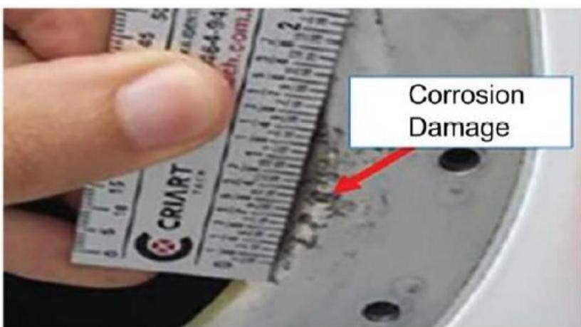
Corrosión que ocurre en el tanque de combustible debido a un drenaje inadecuado para eliminar el agua de los tanques en una aeronave en condiciones de almacenamiento inadecuado, pruebas microbiológicas poco frecuentes o un uso inadecuado del aditivo Biobor JF en el combustible.
