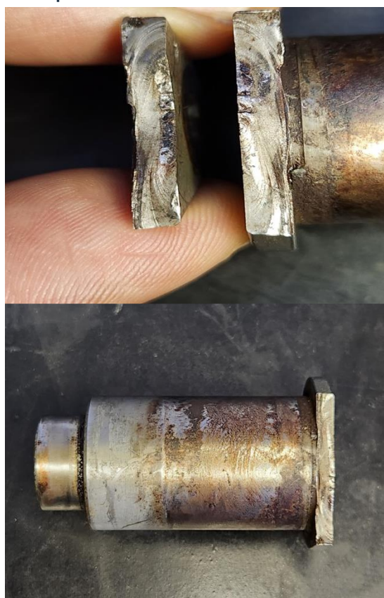
Figura 1: Fractura en la oreja pin de la leva colectiva
