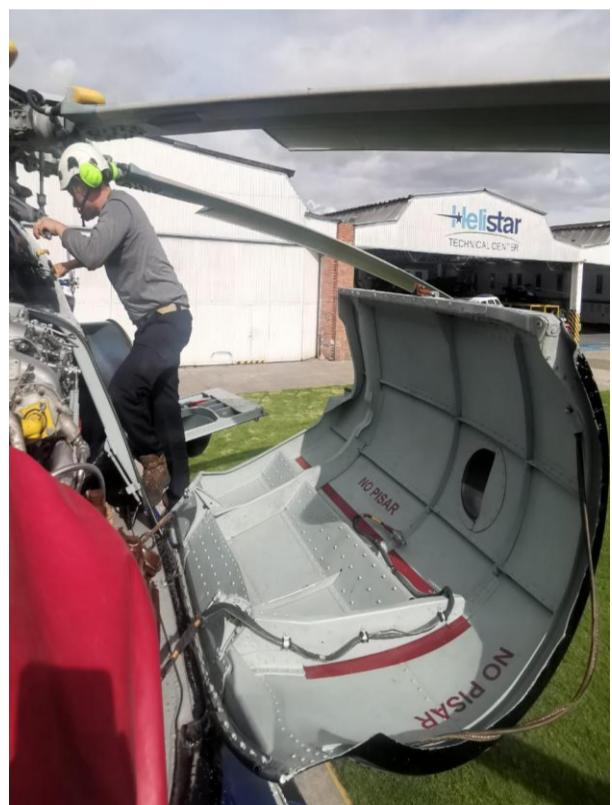
10. Realice apertura y despliegue de la segunda compuerta del motor, hacer uso de las manijas amarillas para agarrarse y evitar alguna caída durante el procedimiento.
